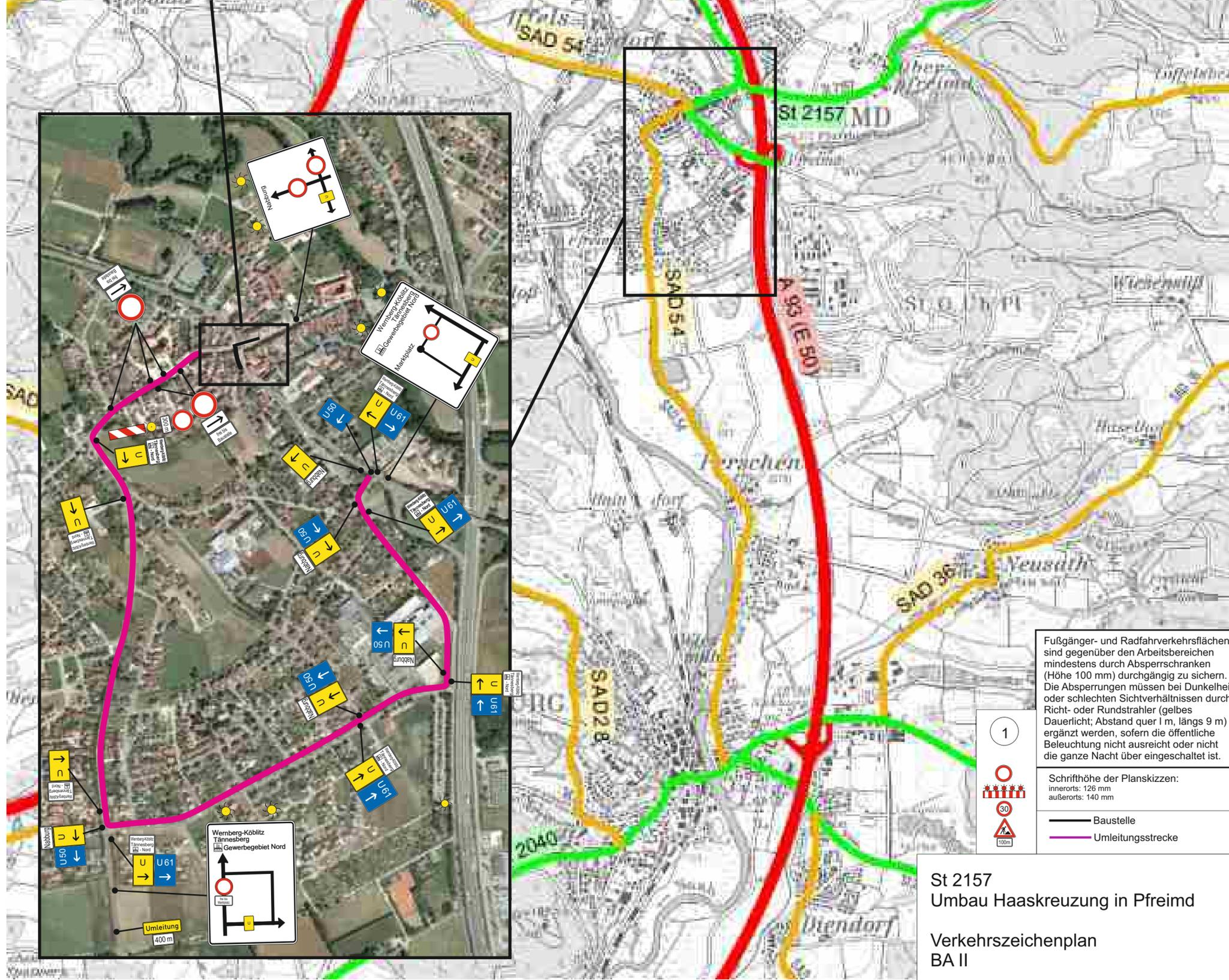
Fußgänger- und Radfahrverkehrsflächen sind gegenüber den Arbeitsbereichen mindestens durch Absperrschranken (Höhe 100 mm) durchgängig zu sichern. Die Absperrungen müssen bei Dunkelheit oder schlechten Sichtverhältnissen durch Richt- oder Rundstrahler (gelbes Dauerlicht; Abstand quer 1 m, längs 9 m) ergänzt werden, sofern die öffentliche Beleuchtung nicht ausreicht oder nicht die ganze Nacht über eingeschaltet ist.
